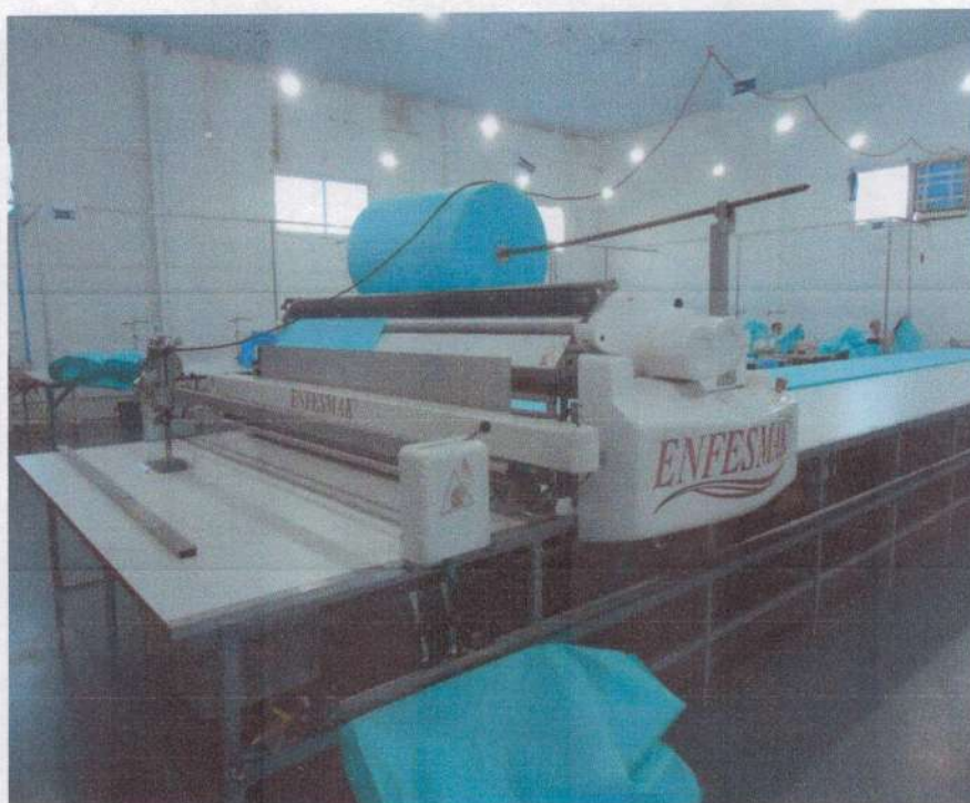
Figura 1: A enfestadeira Enfesmak, com sua mesa de corte de trilhos, calha e corrente condutora de eletricidade, mais suporte para máquina cortadora que está bem a direita da foto.
