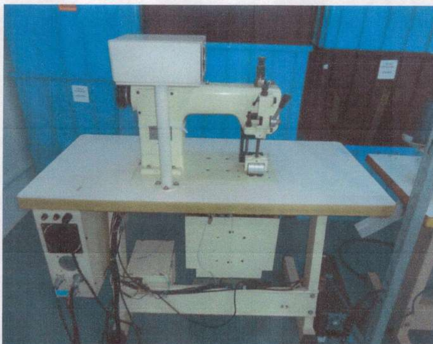
Figura 9: A máquina de costura Ultrasonic MCU 3005 marca K Sonic com sua mesa e acessórios.
