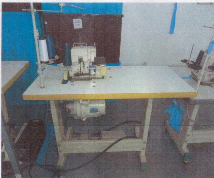
Figura 13: A máquina Overlock 4F, de registro MCO3015, marca Kombat, com sua mesa e acessórios.
