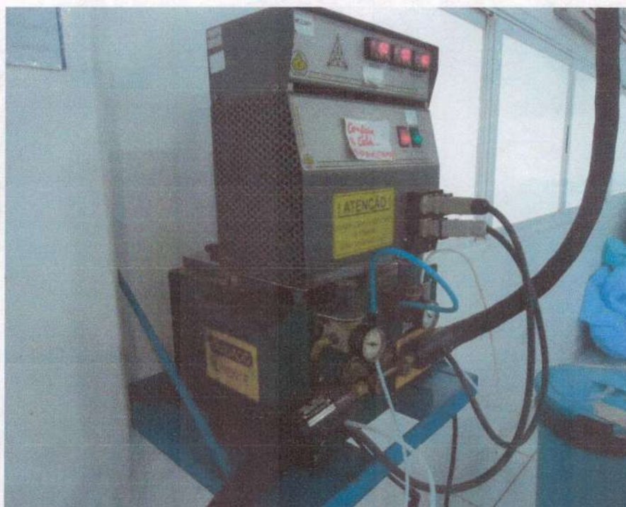
Figura 4: Vista lateral esquerda da Máquina de Cola Mastergam JR,com 2 Mangueiras e 2 pistolas, instalada e funcionando.
